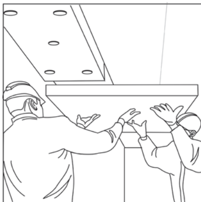
Рисунок 6.4 – Установка теплоизоляционной плиты к месту монтажа
