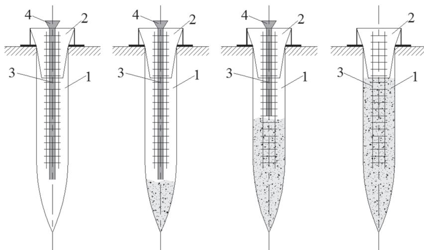
1 – скважина; 2 – бетонолитная воронка; 3 – арматурный каркас; 4 – бетонолитная труба
