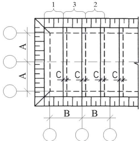
A, B – расстояние, соответственно, между продольными и поперечными разбивочными осями сооружения;
