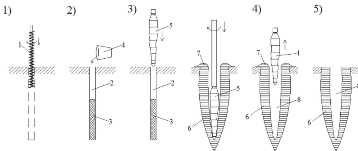
1 – шнековое бурение скважины; 2 – лидерная скважина; 3 – разрыхленный грунт;
