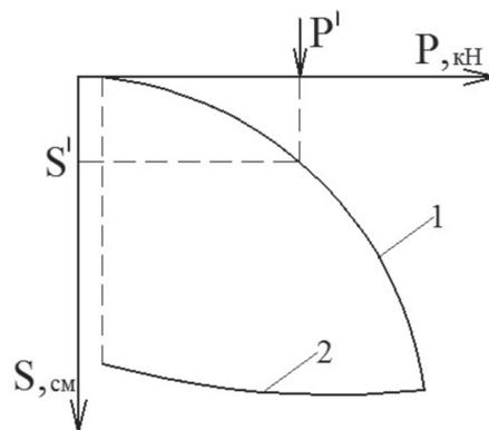
1 – кривая нагружения фрагмента; 2 – кривая разгрузки фрагмента;
