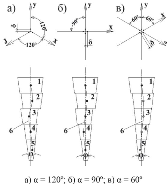
1 – 5 – номера сегментов;  $y, x, j$  – оси поперечного сечения;  $z$  – продольная ось;  $\varphi$  – угол при вершине;
