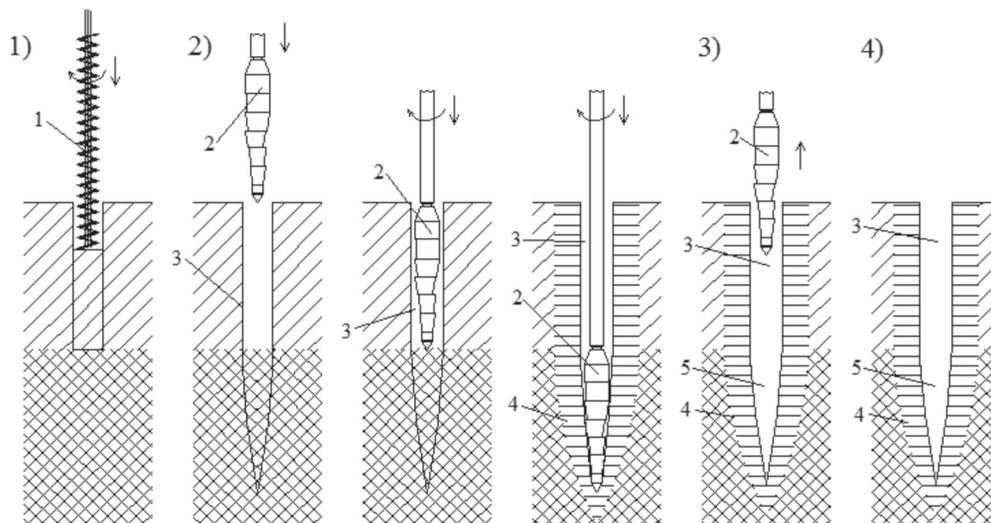
1 – шнековое бурение; 2 – раскатчик; 3 – буровая часть скважины;
