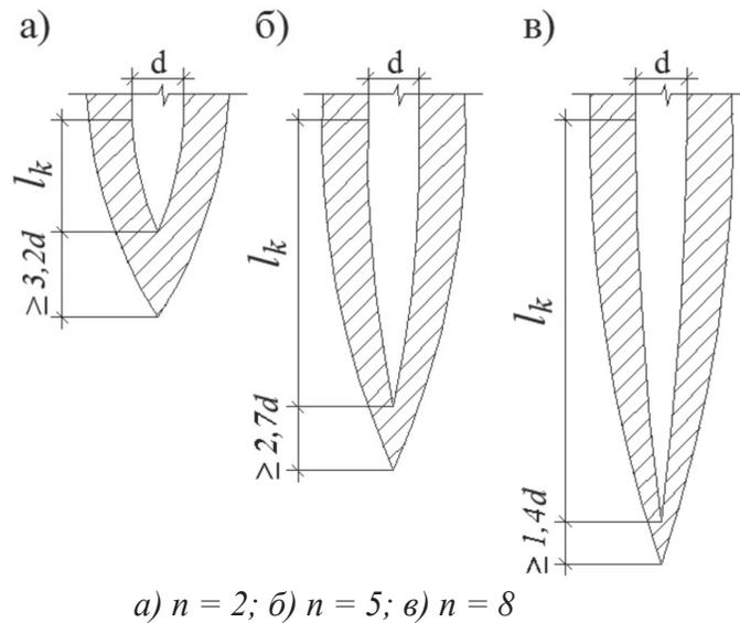
Рисунок 42 – Схема формирования уплотненной зоны околоскважинного пространства ниже острия скважины в зависимости от величины  $n$
