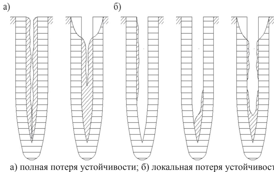
Рисунок 43 – Схемы потери устойчивости ствола раскатанных скважин
