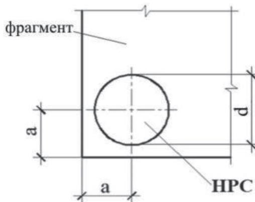
Рисунок Г.4 – Схема назначения расстояния ( $a$ , мм) от продольной оси НРСн до края фрагмента фундамента
