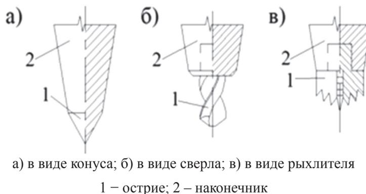
Рисунок 19 – Типовые конструкции острия наконечника РСу
