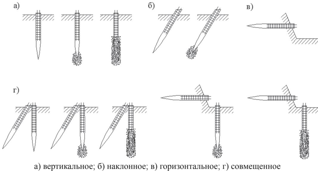
Рисунок 10 – Схемы расположения НРСн в грунтовом массиве
