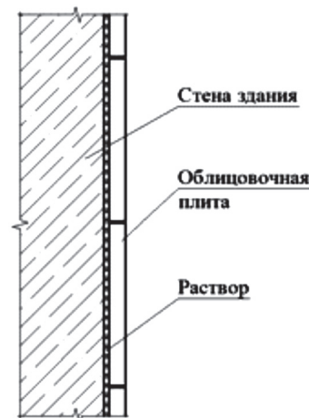
Рисунок 4 – Схема устройства облицовочного слоя тип 4 (рядовой участок)
