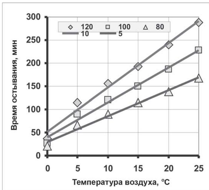
Рисунок В.2 – Время остывания холодной асфальтобетонной смеси до температуры 25 °C
