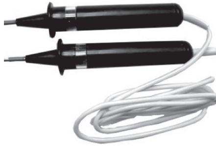
Рисунок А.3 – Указатели низкого напряжения
