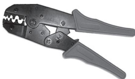
Рисунок А.6 – Пресс-клещи для опрессовки кабельных наконечников
