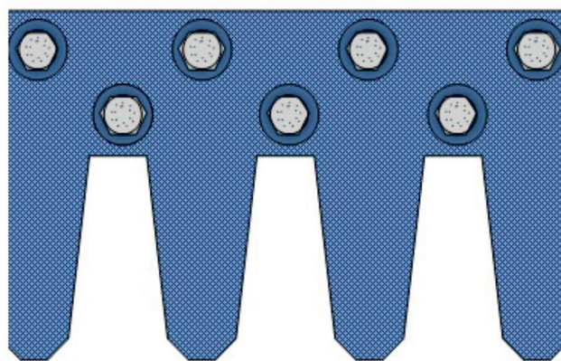
Рисунок Б.14 – План гребенчатой плиты с уширенными к основанию (трапецеидальными) в плане зубьями (фрагмент)
