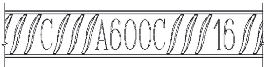
Рисунок 5.1 – Маркировка арматурного проката класса Ан600С
