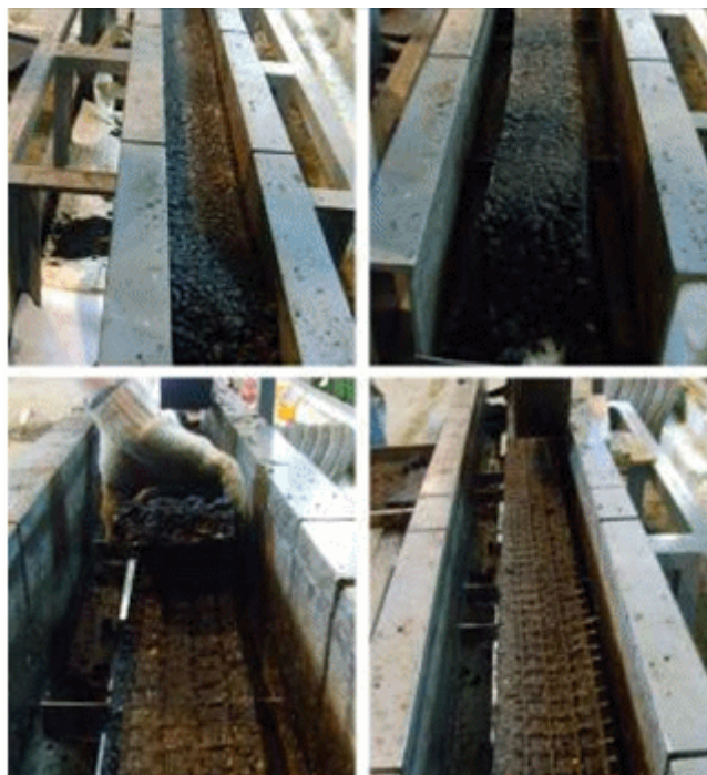
Рисунок Г.6.2. Процесс извлечения геосетки из конструкции
