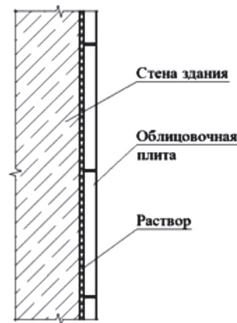
Рисунок 4 – Схема устройства облицовочного слоя тип 4 (рядовой участок)
