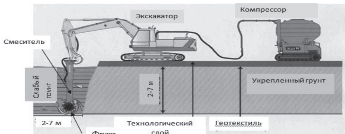
Рисунок 2 – Схема производства работ по укреплению слабого грунта в массиве [4], [5]
