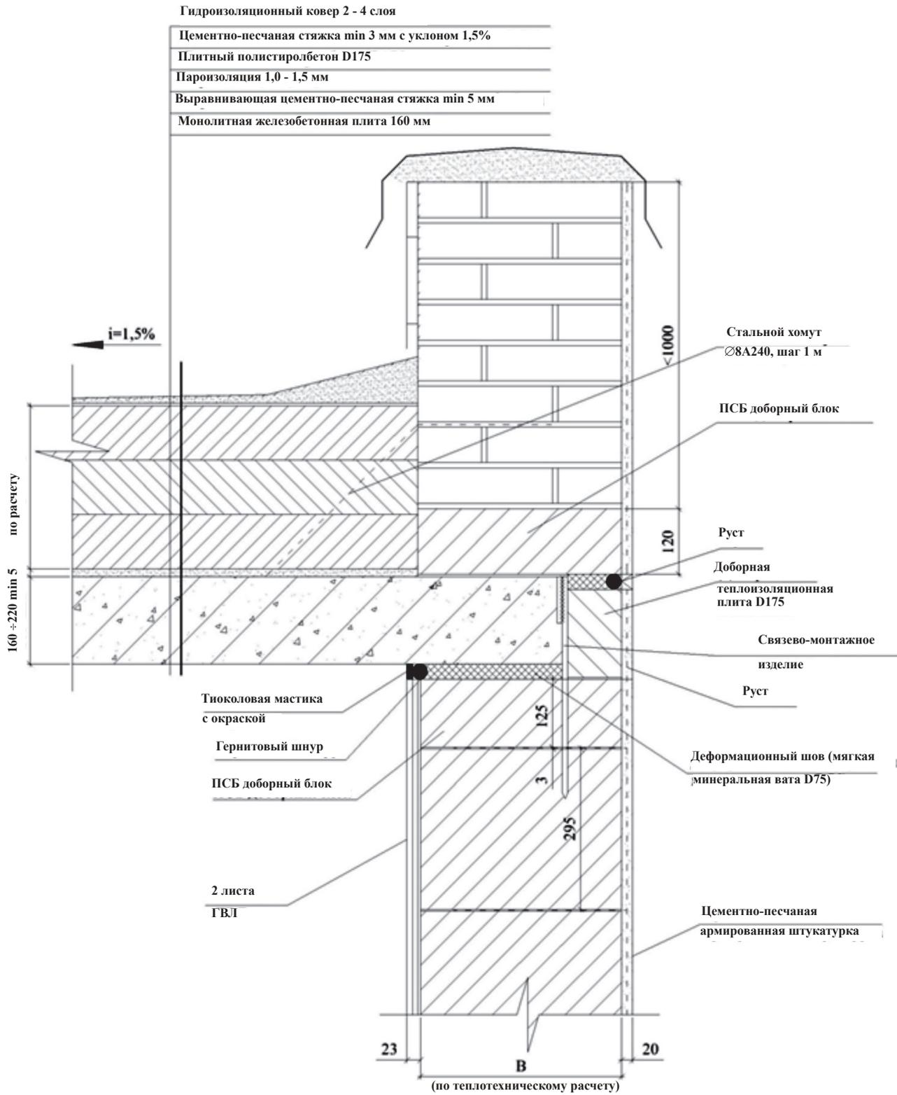
Рисунок 6.12 – Утепление покрытия здания с использованием плитного полистиролбетона
