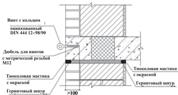
Рисунок 6.22 – Крепление навесных устройств к фасадам стен
