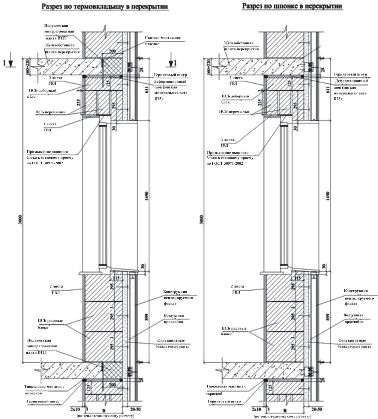
Рисунок 6.8, лист 1 – Несущая стена из ПСБ блоков с вентилируемым фасадом.
