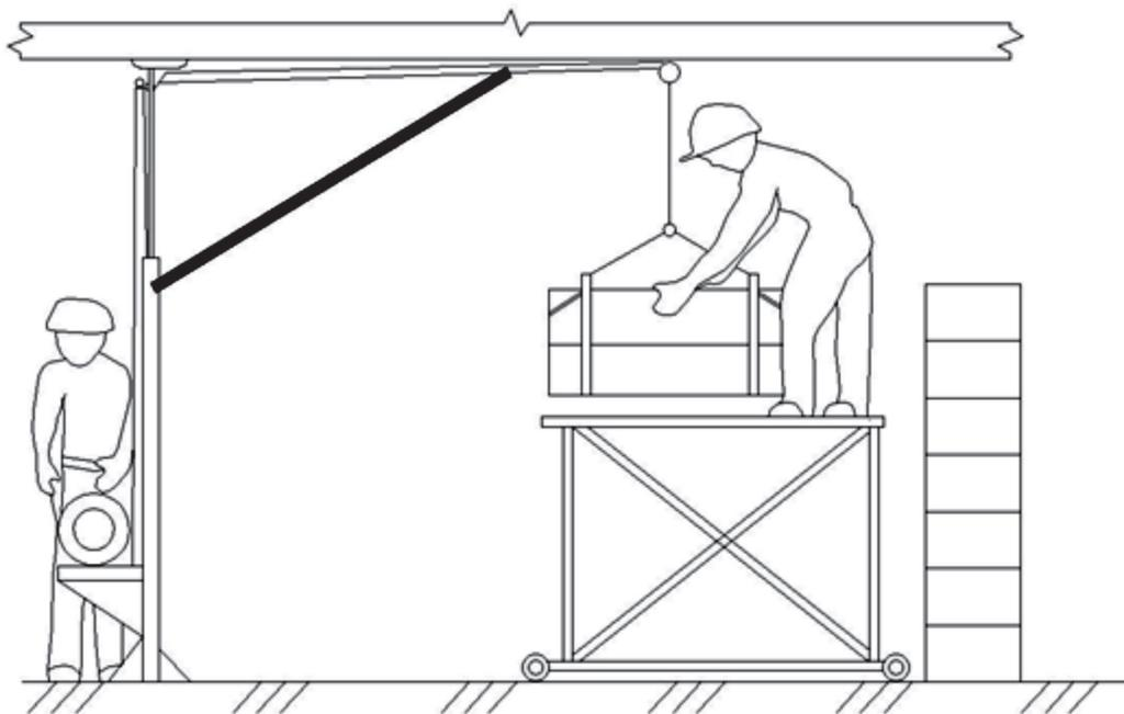
Рисунок 7.2 – Подача блоков на подмости краном-укосиной
