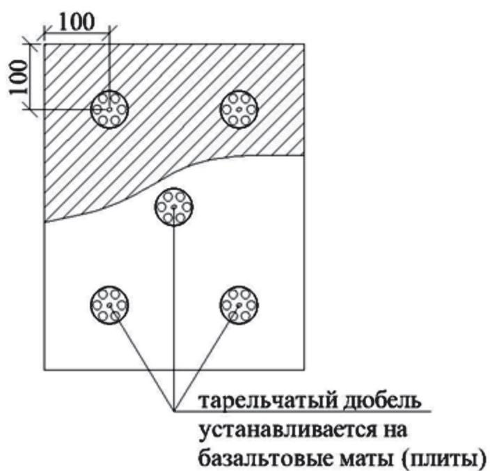
Рисунок 7.3 – Монтаж утеплителя и установка тарельчатых дюбелей
