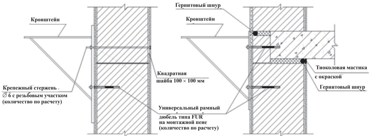
Устройство для крепления растяжек (при расчетном обосновании)
