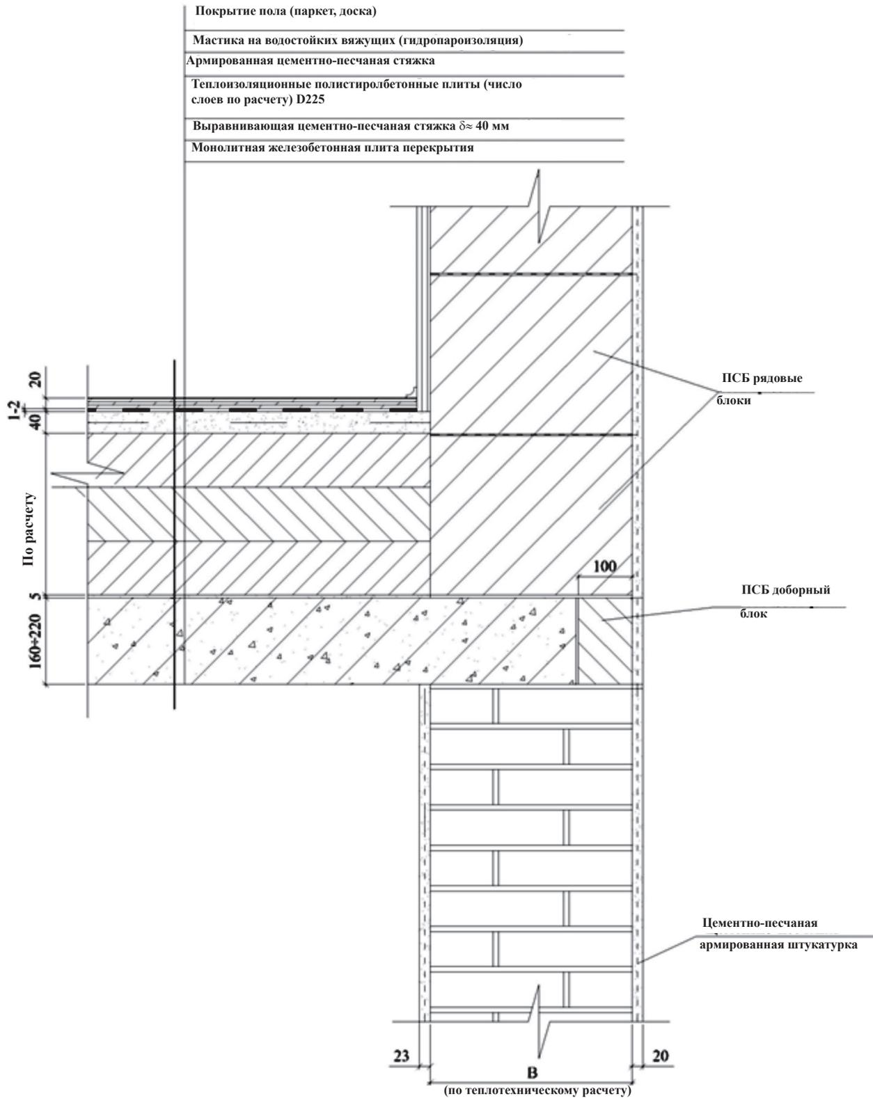
Рисунок 6.14 – Утепление перекрытия над холодными подвалами (подпольями, проездами) с использованием теплоизоляционных плит из полистиролбетона
